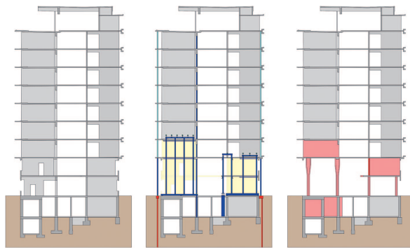
Fig. 10 Umbaukonzept Foyer: Bestand/Notspriessung und Abbruch/Neubau.
